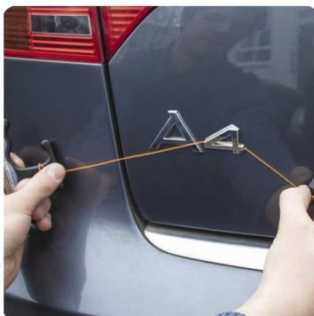
Filo per rimozione loghi biadesivizzati
